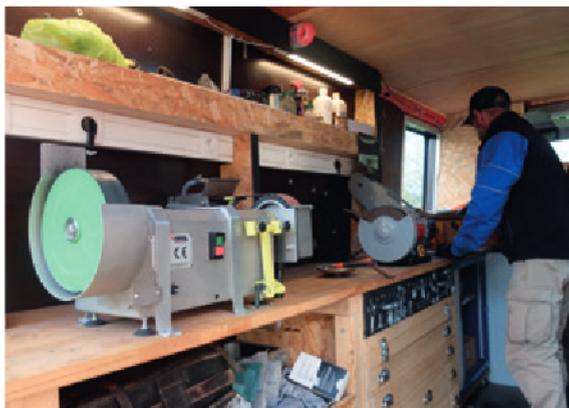
**La position de travail doit être bien stable. Le camion doit être posé de niveau pour affûter correctement.**
