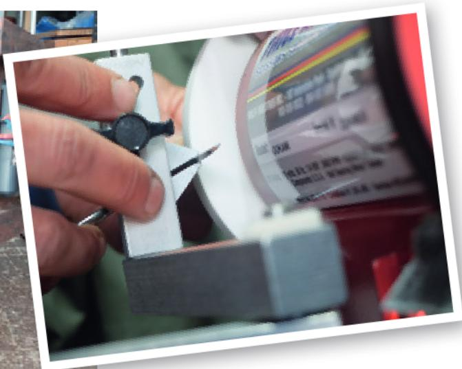
**Les guides permettent de respecter parfaitement les angles de coupes d'origines. Ici un ciseau de coiffeur en cours d'affûtage**
