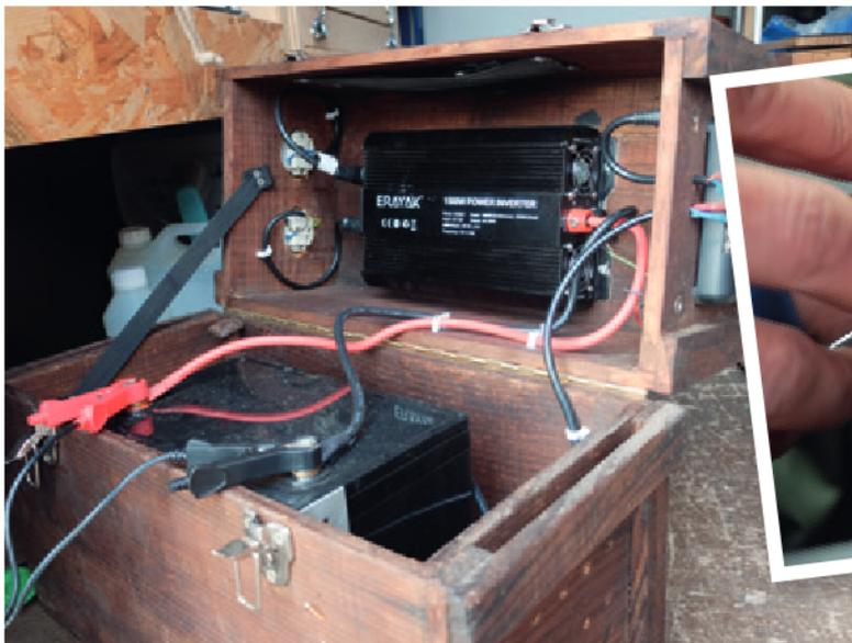
**La batterie lithium accumule l'énergie des panneaux solaires, le convertisseur transforme ensuite l'énergie en 220v pour faire tourner les machines. C'est un ECOFLOW fait maison.**
